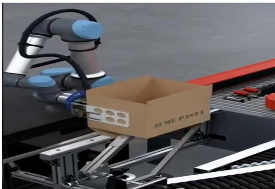
Exemple de produit standard de façonnage de cartons via cobot
